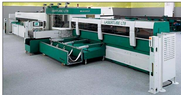
*Geplante Investition für den Betrieb der Vorfertigung – ADIGE LASER TUBE LT8*
