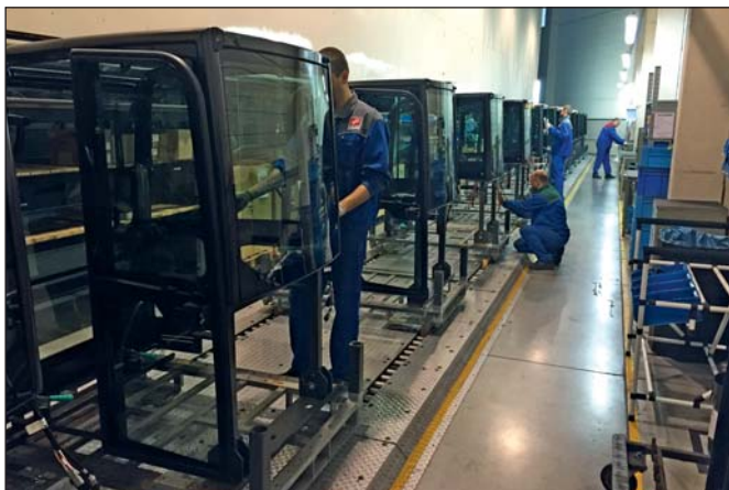
Montážní linka pro kabiny BOBCAT
