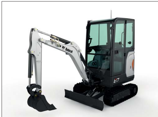
Mini-bagr BOBCAT E17 osazen kabinou C2 (CTS)
