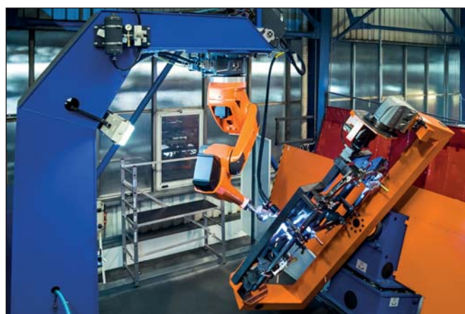
Nový robot C60 při svařování bezpečnostních rámu pro firmu DYNAPAC
