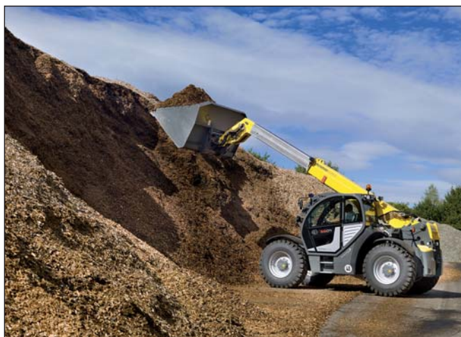
Teleskopický nakladač firmy KRAMER s kabinou z Vyškova „v akci“
